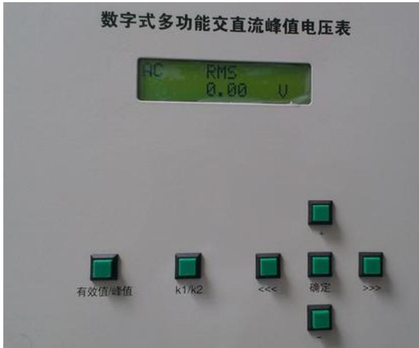
本仪器采用 DSP 运算内核和数字量信号处理技术，通过实时信号波形分析，幅频计算。在设计方面采用了先进的抗 EMC 设计，使本产品
